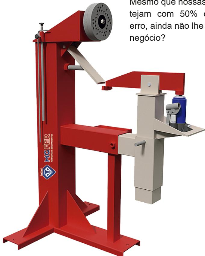
Este equipamento foi desenvolvido para recuperação de rodas amassadas (não trincadas), de alumínio ou de ferro.
