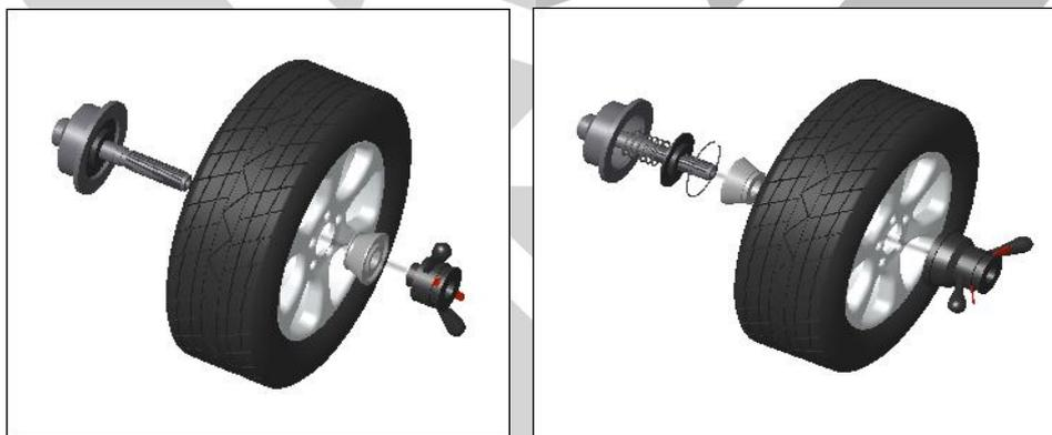
**Nota: quando colocar ou remover a roda, não é permitido deslizar a roda na rosca do eixo principal, para evitar qualquer deformação da mesma.**
