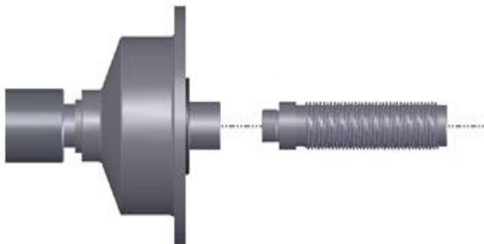
**Nota:** ao colocar e retirar as rodas, não é permitido deslizar a roda na rosca do eixo principal para não danificar a rosca.
